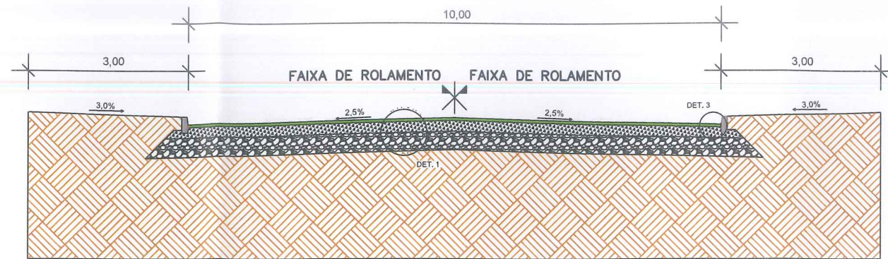
DETALHAMENTO EM CORTE RUA SENO K. ESC.: 1/100
